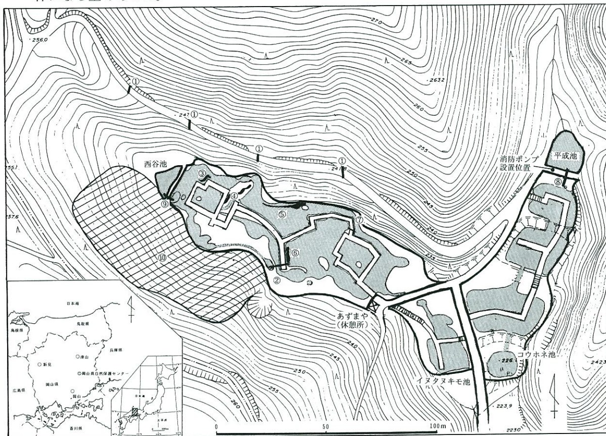
図1. 湿生植物園の位置および名称。右側を「東の谷」、左側を「西の谷」と呼ぶ。網掛けで示した範囲は水が常時ある場所を示している。図中の番号はその後の改良が加えられた地点を示す。①北側の林道に設けられた横断側溝、②地下水路（ビニル管）、③～⑦湿原内部で新しく造った水路。⑧平成池から東の谷への地下水路（ビニル管）、⑨西谷池から西の谷への水路（ビニルホース）、⑩アカマツ林内の下刈りした範囲。
