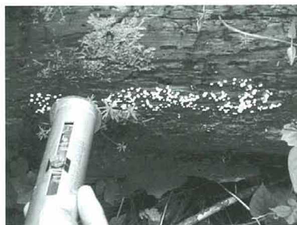
図2. 土壤硬度計による材の硬さの測定 (ツノホコリの発生部位)。
